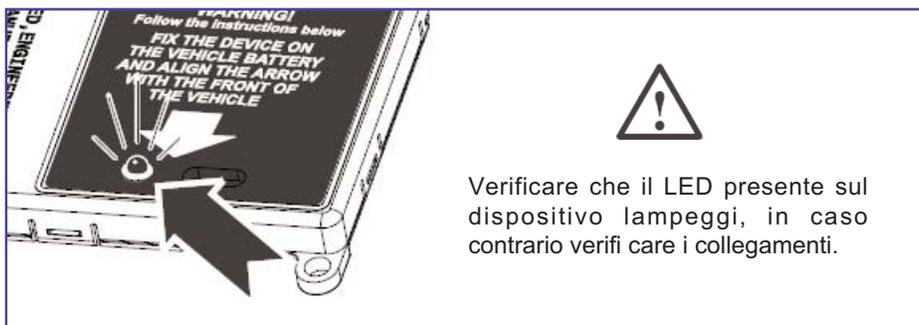
Sul dispositivo è presente il LED di verifica che emette delle sequenze di lampeggio in base alla tipologia di registrazione sulla rete GSM.
